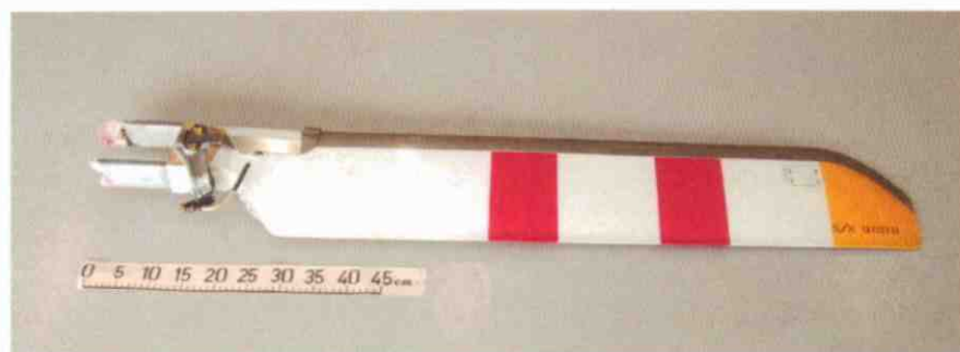
Foto nº1: Aspecto geral da pá arrancada.
