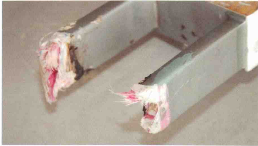
Foto nº2: Aspecto da ruptura ocorrida, lado da pá.
